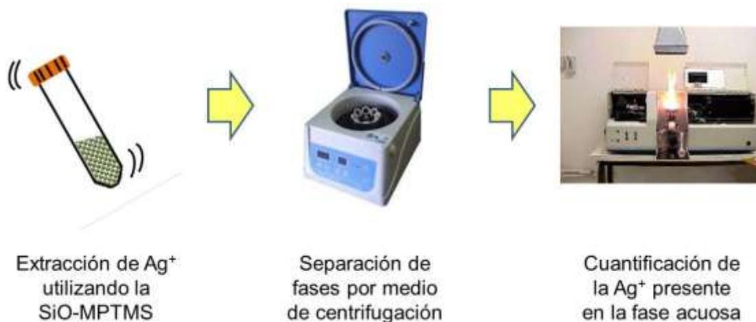
Figura 3.2. Proceso de extracción con SiO-MPTMS.
