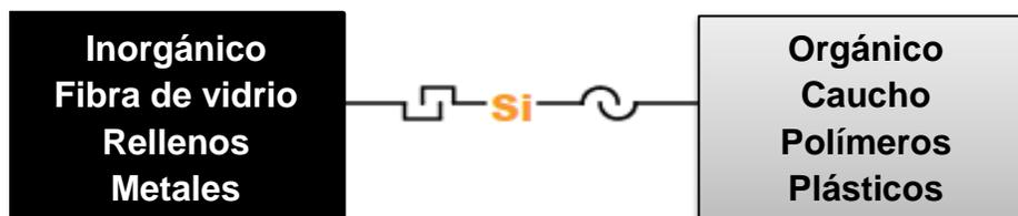
Figura 1.5. Mecanismo de acoplamiento de un organosilano.
