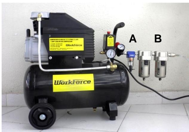
Figura 10. Modificaciones al compresor. (A) filtro lubricador. (B) filtros de aire.
