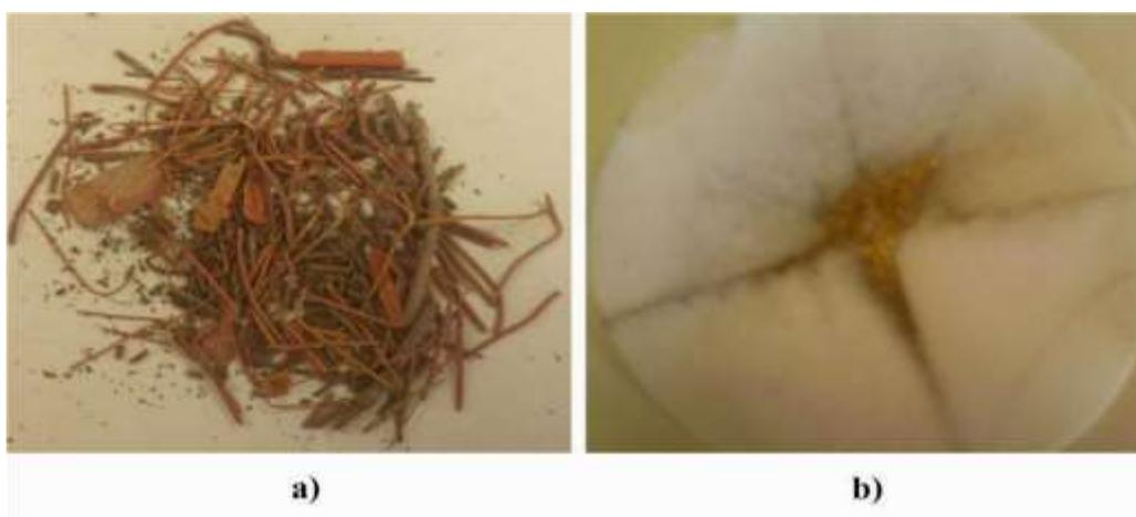
**Figura 38.** Fotografía de los Productos de la lixiviación dinámica ácido de los componentes que contienen oro. En un tiempo total de reacción de 240 minutos: a) pines de lixiviados y b) partículas de oro.
