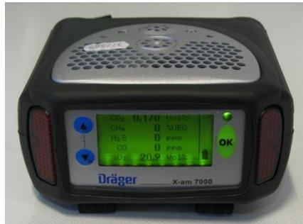
Figura 6.1.- Equipo Dräger utilizado para medir el contenido de gas en los barrenos de la frente de trabajo.
