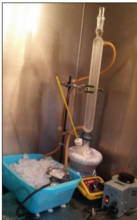
Figura 21.- Fotografía del sistema utilizado para la síntesis de nanotubos de TiO 2 .
