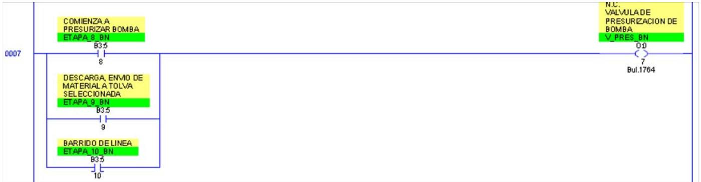
Figura 2.14: Subrutina: Activación de salidas del programa
