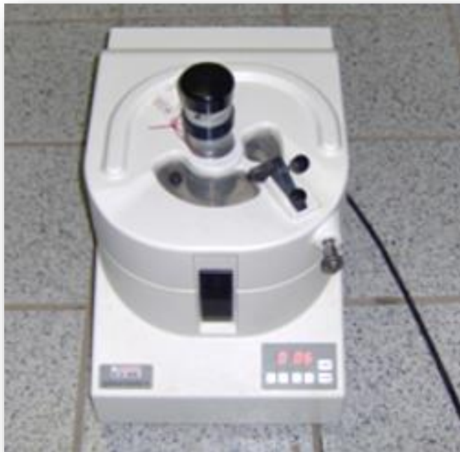
Figura 8: Molino Pulverisette II, el cual consta de un mortero de ágata.
