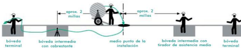
Figura A.11 Extracciones largas a través del conducto, técnica de extracción a medio punto
