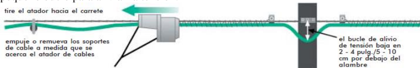
Figura A.5 Paso del atador de cables en el poste.
