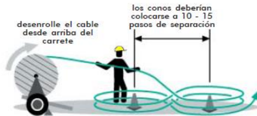
Figura A.2 Desenrollado del cable.
