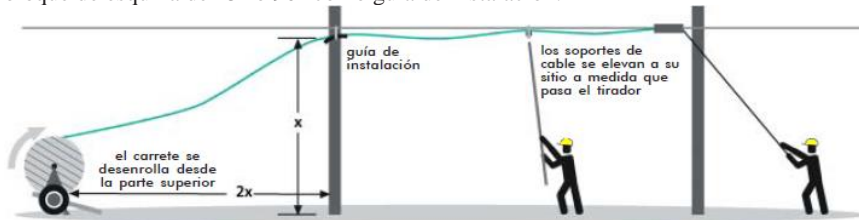
Figura A.3 Instalación en configuración de enrollado retractable/fijo.
