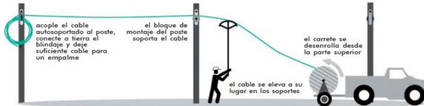
Figura A.9 Instalación del cable autoportado con el método de instalación con desplazamiento de carrete.
