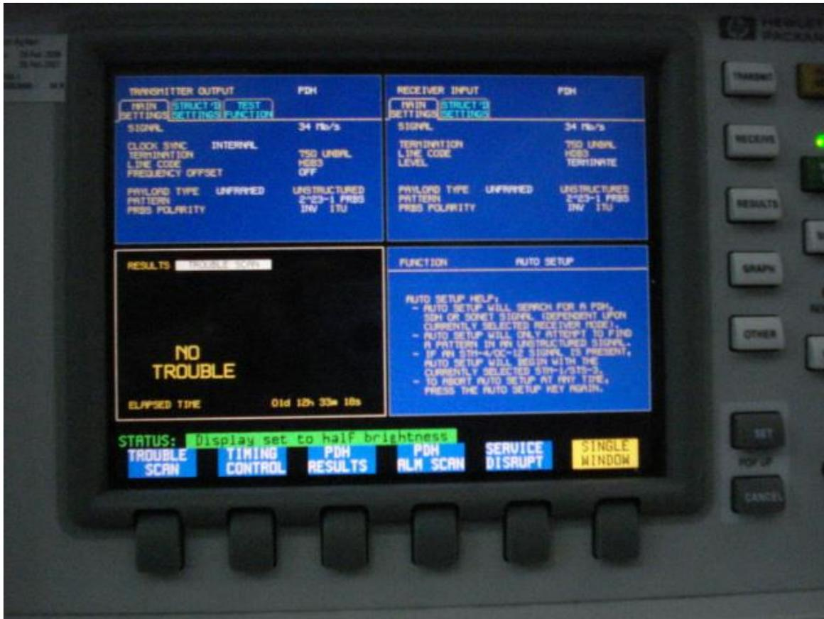
Figura 41. Muestra la Pantalla del Equipo al Término de la Prueba sin Errores.
