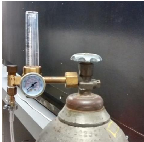
Fig. 33 Monitoreo de flujo de CO 2 .
