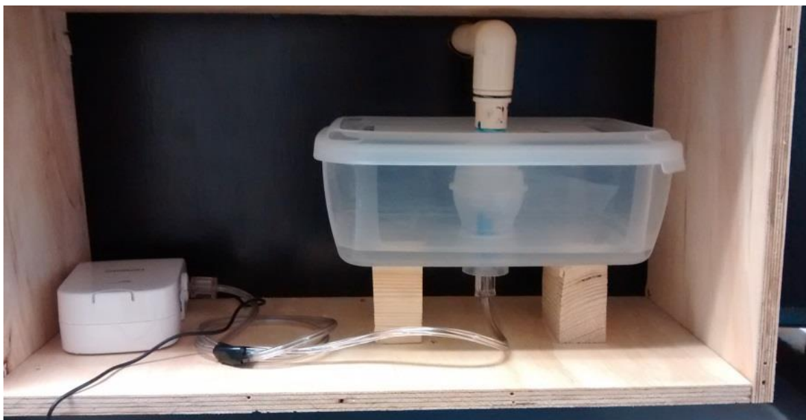
Fig. 25 Instalación del Kit humidificador a la cámara de carbonatación (Dispositivo real).
