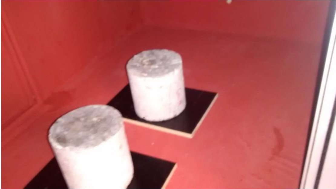
Fig. 32 Especímenes de concreto dentro de la cámara de carbonatación en funcionamiento.
