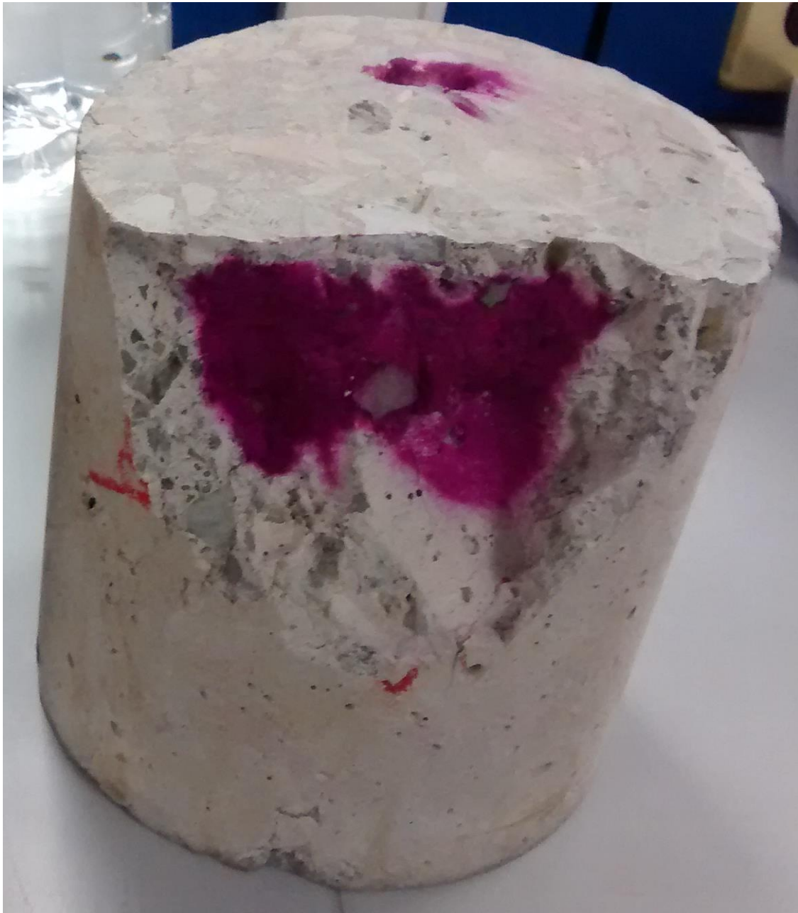
Fig. 43. Cilindro 2 con exposición a la cámara (fenolftaleína).
