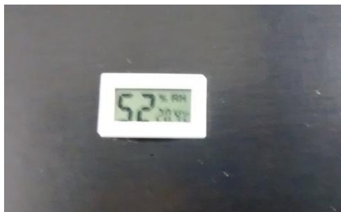
Fig. 29. Primera lectura del termohigrómetro al iniciar la prueba de humedad.
