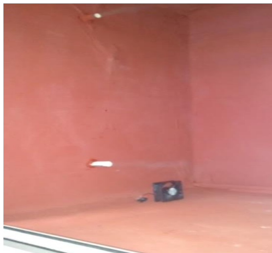
Fig. 30 Interior de la cámara de carbonatación con sistema de humidificación encendido (dispositivo real).
