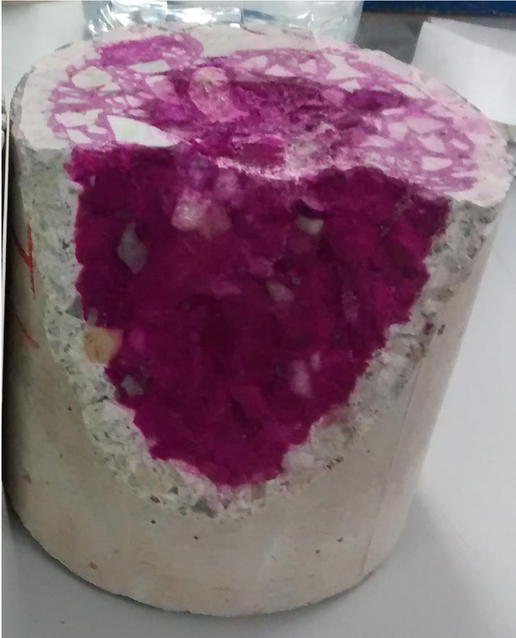
Fig. 42. Cilindro 2 sin exposición en la cámara (fenolftaleína).
