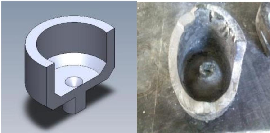
**Figura 3.1** Boquilla dosificadora de fibra cerámica de horno calentado pro arco eléctrico.
