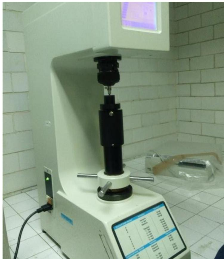
**Figura 2.3** Escleroscopio 713 SRD con indentador de bola de diamante.
