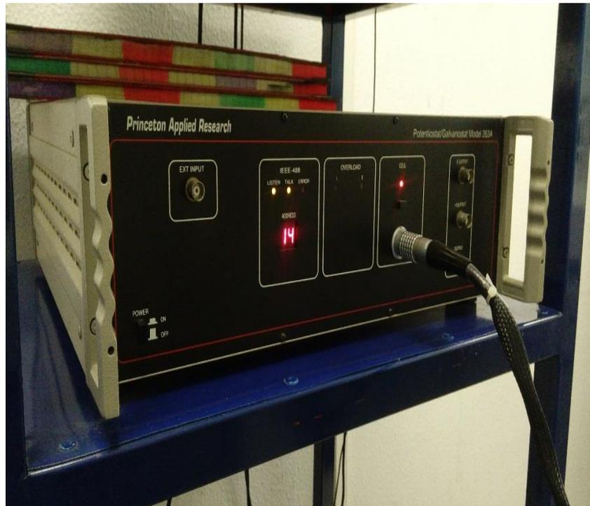
**Figura 2.7** Potenciostato/galvanostato Modelo 263A de la marca Princeton Applied Research.
