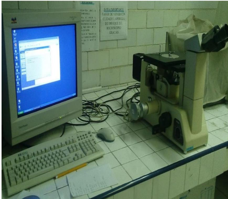
**Figura 2.4** Microscopio metalográfico marca Nikon con analizador de imagen.
