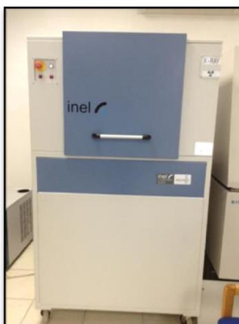
**Figura 14.** Difractómetro de rayos X marca *INEL EQUINOX 2000*.
