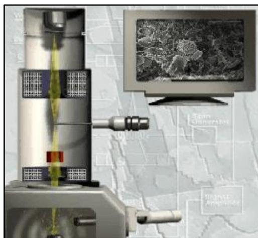
**Figura 15. Microscopio Electrónico de Barrido JEOL modelo JMS-6300.**
