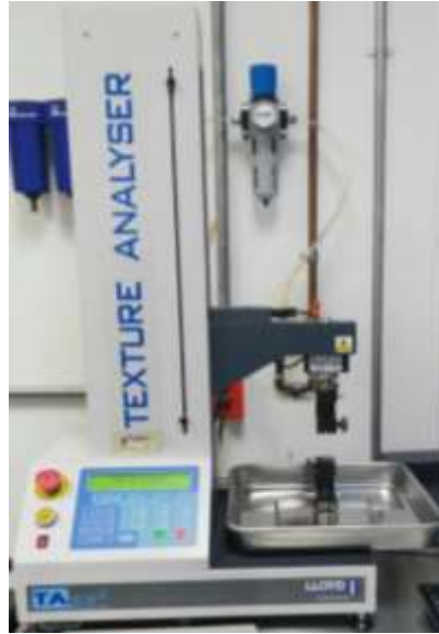
Figura 16. Máquina universal (TA plus, Lloyd) donde se realizaron las pruebas mecánicas.
