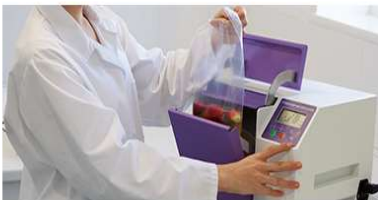
Figura 15. Homogeneización en Seward Stomacher® 400 Circulator a 300 rpm por 5 min.
