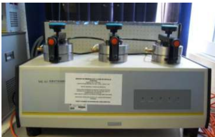
Figura 17. Equipo para medición de permeabilidad al oxígeno VAC-V2 Permeability tester.
