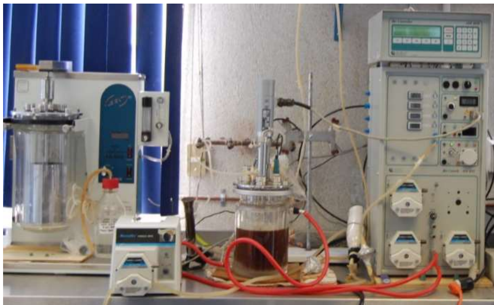
Figura 9. Fotografía de biorreactor tanque encaquetado de 3L (Applikon Biotechnology).
