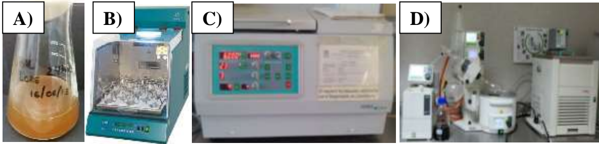
Figura 8. Algunas de las etapas para la producción del CAM por Streptococcus infantarius . A) Fermentación a nivel matraz. B) Incubación con agitación orbital. C) Separación de biomasa mediante centrifugación. D) Concentración en rotavapor con controlador de vacío.
