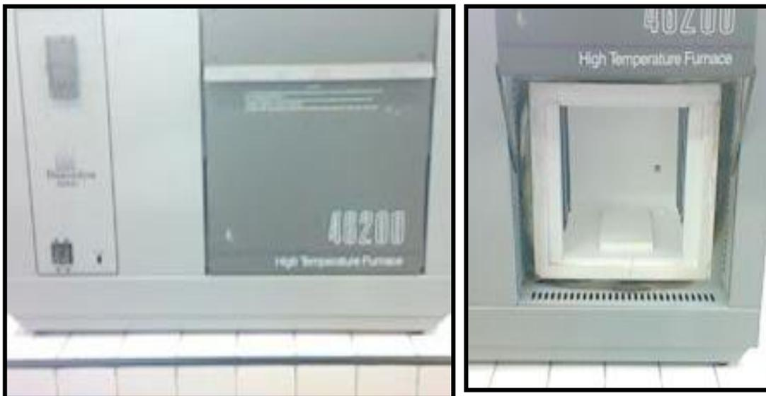
**Figura 7.- Horno de mufla donde se sinterizo Temp. Máx. 150 °C.**
