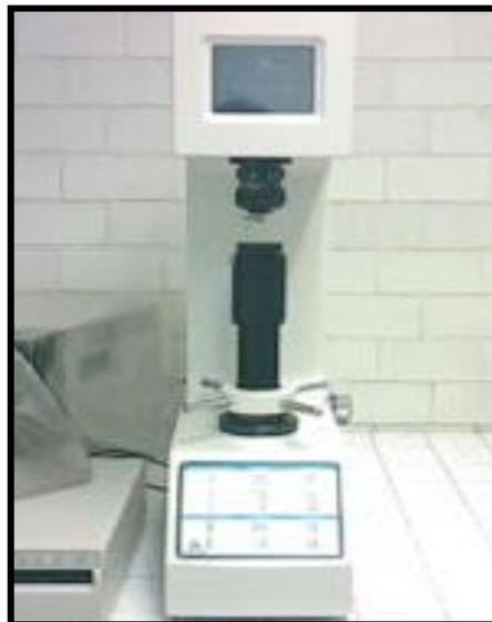
**Figura 3.- Macrodurómetro.**
