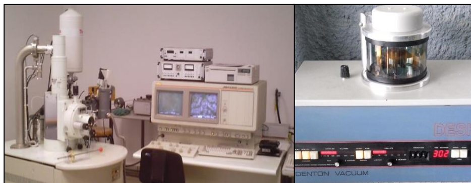
Figura 12. Microscopio electrónico de barrido (modelo JEOL JSM-5600 Akishima, Tokyo, Japón).
