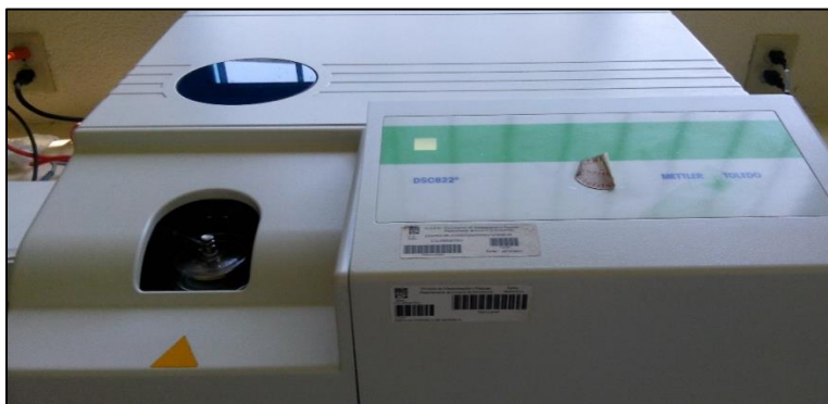
Figura 13. Calorímetro diferencial de barrido (Modelo 822E. Mettler Toledo, Griefensee, Zurich Sz).
