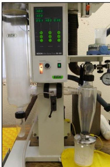
Figura 14. Mini Spray Dryer, Modelo B-191. BÜCHI
