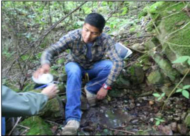
Figura 4.1. Muestreo y envasado, se observa el proceso de muestreo en frascos de 1L y el llenado de frascos de 50ml (muestra del manantial el contadero).
