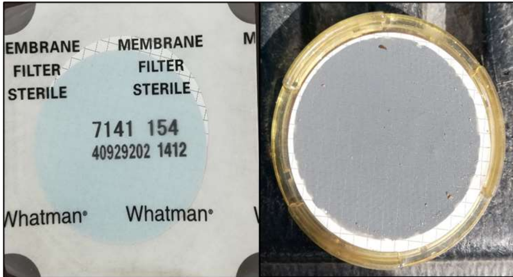
Figura 4.2. Filtro Whatman de 0.45\mu\text{m} , en la izquierda se observa el filtro nuevo en su empaque, a la izquierda el filtro en la boquilla de la bomba de presión posterior a su uso mostrando una gran cantidad de partículas atrapadas (muestra CH12).
