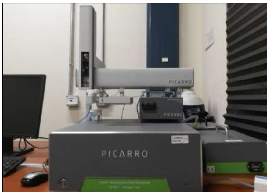
Figura 4.6. Espectrómetro de Masas de Relaciones Isotópicas (IRMS); marca Picarro modelo L2130-i; con detector Cavity Ringdown Spectrometer (CRDS).
