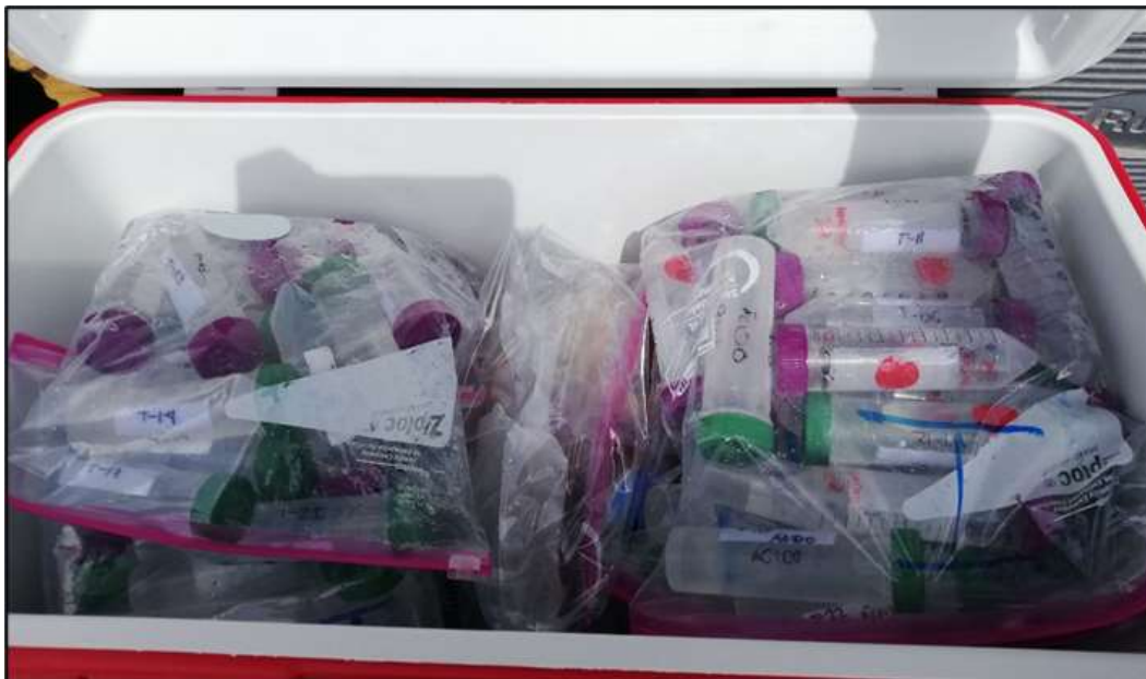
Figura 4.3. Conservación de las muestras en frascos de 50ml a 4^{\circ}\text{C} , se observan separados en bolsas con claves de zona y objetivo de muestreo (aniones, cationes, isótopos), dentro de una hielera para controlar la temperatura.
