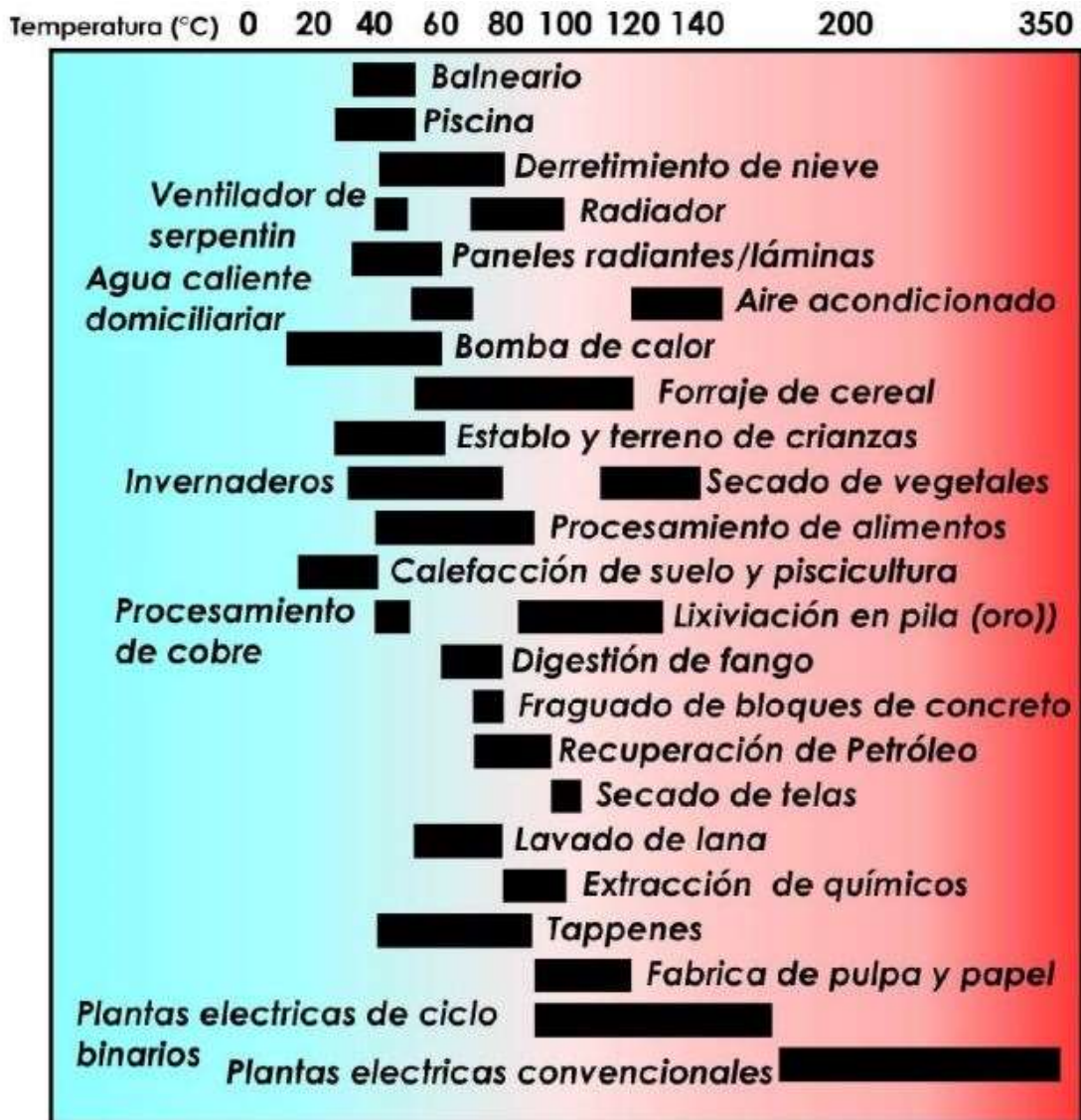
Figura 2.10. Clasificación de los recursos geotérmicos según su temperatura, se observan los usos más comunes (Lindal, 1973).
