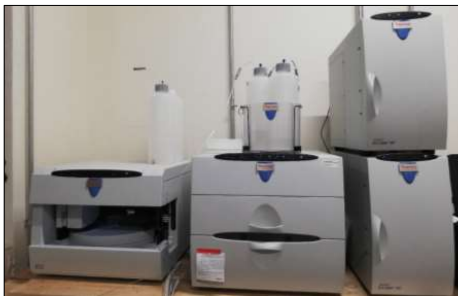
Figura 4.4. Cromatógrafo Iónico; marca Thermo Scientific.modelo Dionex ICS-5000
