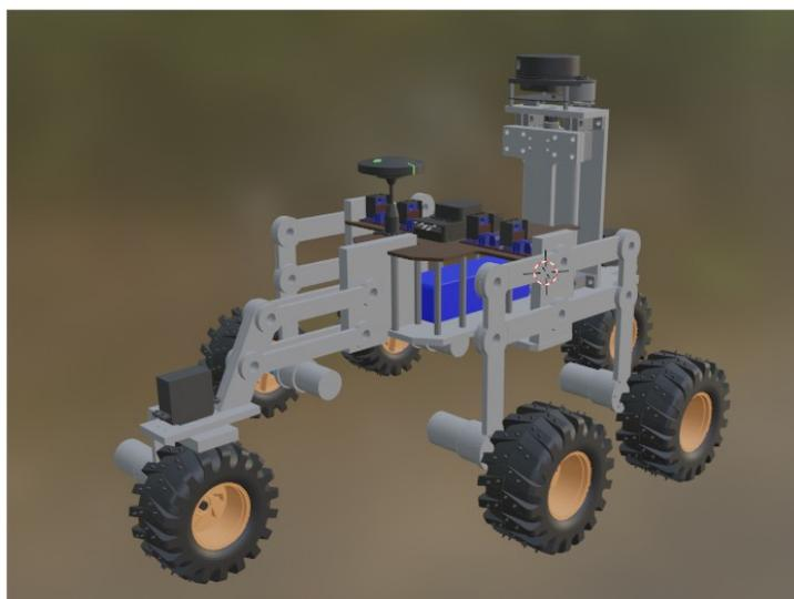
Figura 4.4: Robot con arquitectura shrimp rover.
