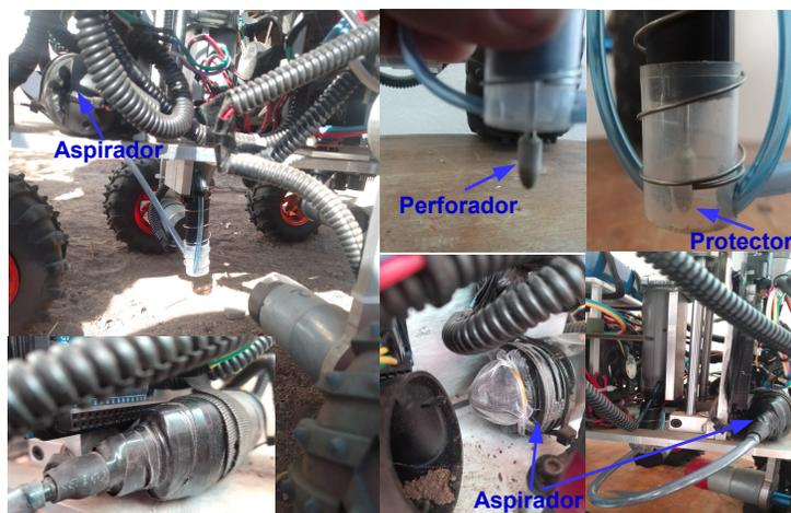
Figura 5.22: Sistema de toma de muestras de suelo.
