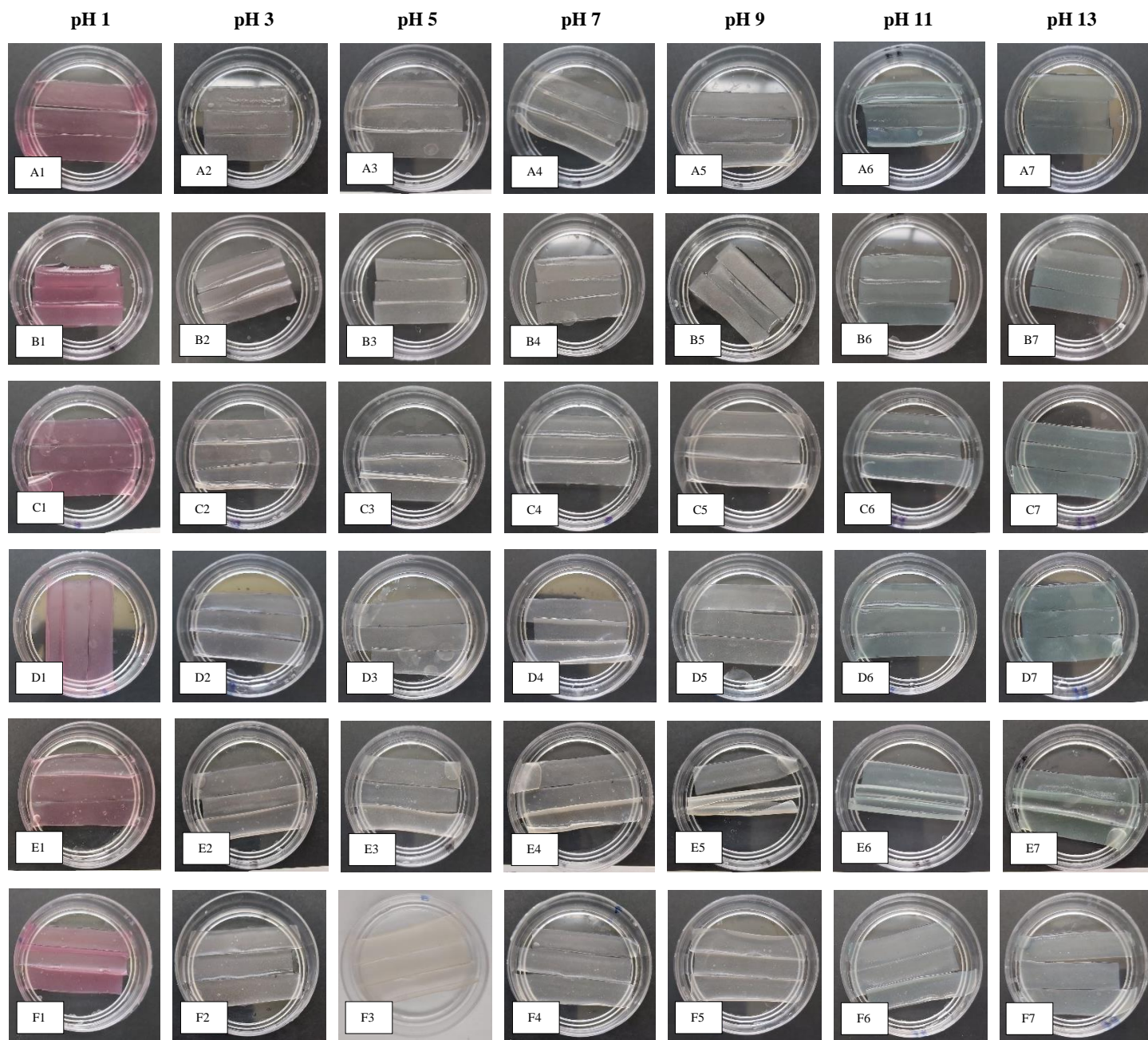
Figura 43. Variaciones de color de las películas hechas con almidón de Oxalis tuberosa , harina de cáscara de Oxalis tuberosa , glicerol y carboximetilcelulosa en soluciones tampón de pH 1, 3, 5, 7, 9, 11 y 13.
