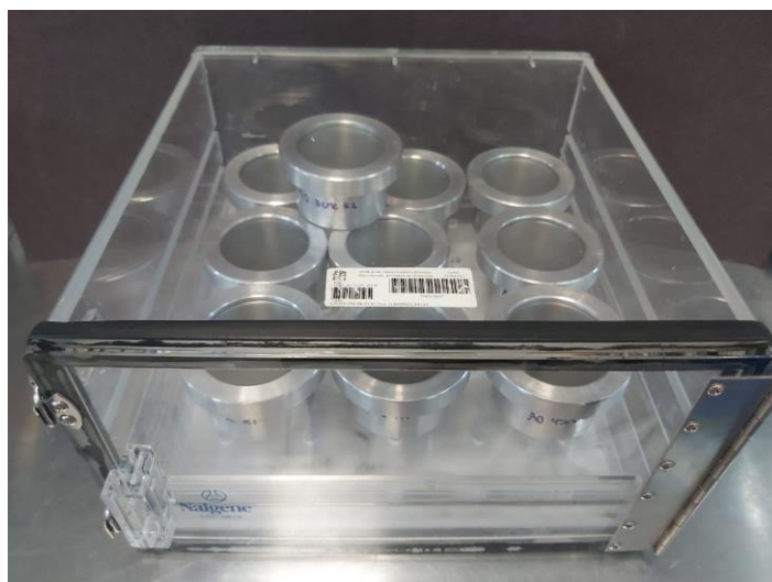
Figura 37. Celdas con muestras de películas para la prueba de permeabilidad al vapor de agua.
