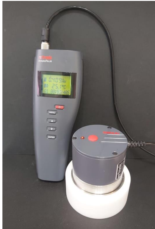
Figura 33. Determinación de la actividad de agua mediante el equipo HygroPalm.
