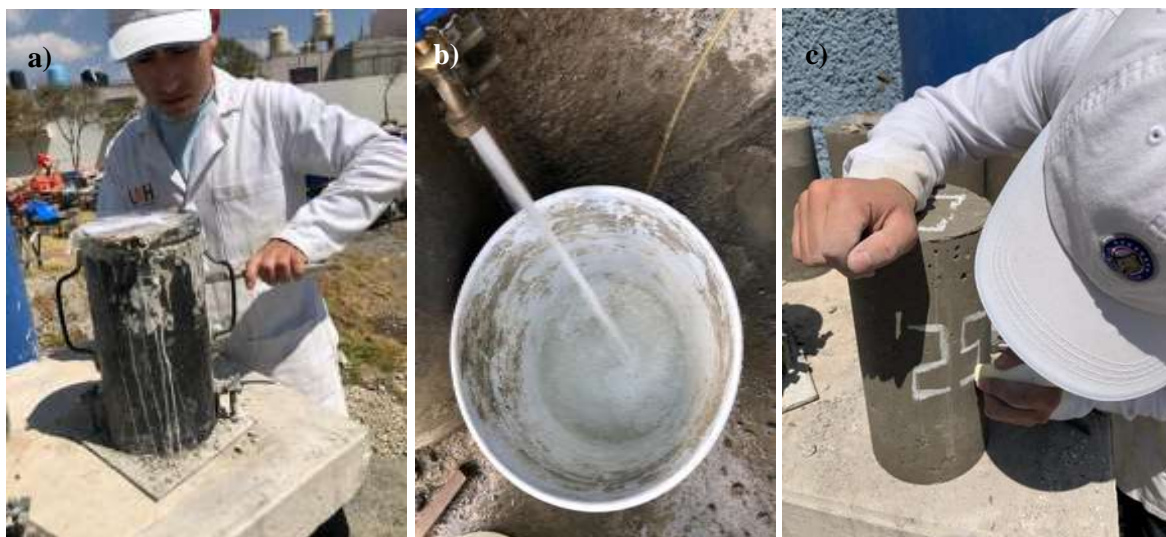
Figura 3.7 Preparación de los especímenes para la etapa de curado. a) Desmontaje de especímenes, b) Preparación de agua para curado, c) marcado de cilindros
