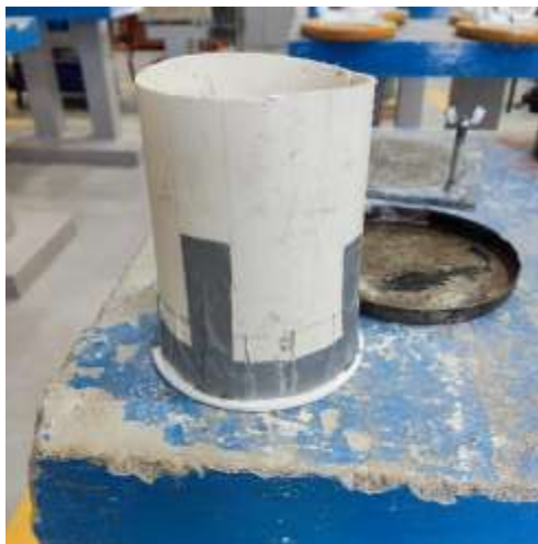
Figura 3.11 Molde de especímenes de pruebas de corrosión y oxidación
