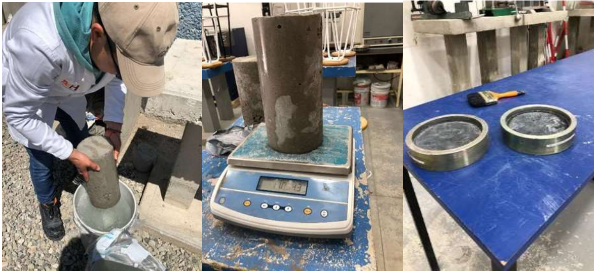
Figura 3.9 Extracción del espécimen, proceso de pesado en báscula y separación de los cabezales de neopreno de los cilindros
