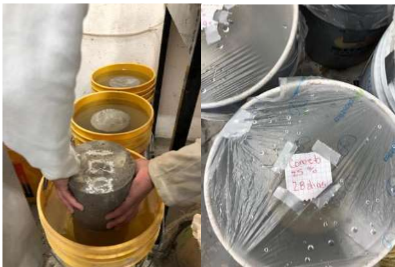
Figura 3.8 Curado de concreto y almacenamiento de especímenes
