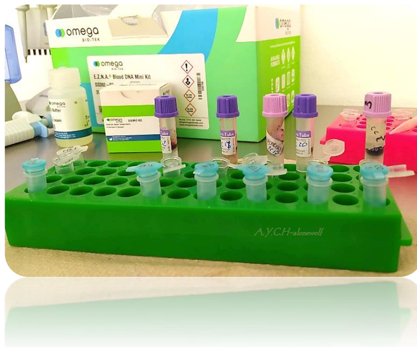
Figura 23 Identificación de muestras para la extracción sanguínea, al igual que la separación de capa leucocitaria para el proceso de extracción usando el kit Omega BIO-TEK
