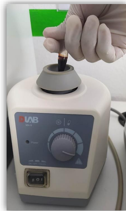
Figura 26 Utilización del vortex para la homogenizar de la muestra con los reactivos del kit.
