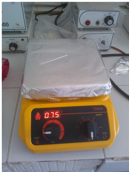
**Figura 3.12.** Tratamiento térmico del sustrato para la eliminación de humedad.
