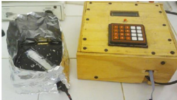
**Figura 3.19.** *Sustrato Con ITO sujeto en el spin coater.*
