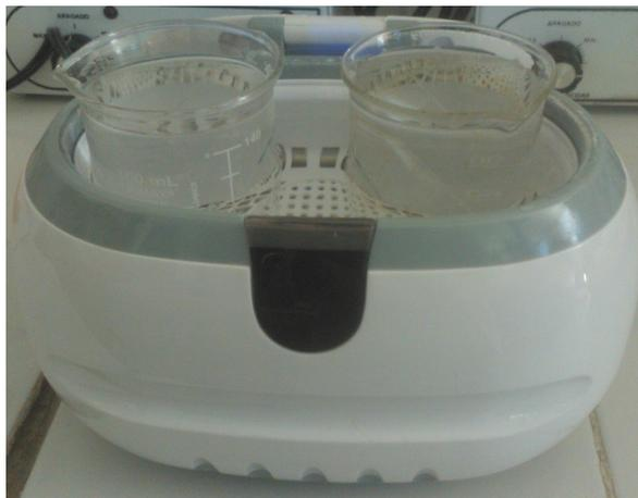
**Figura 3.14.** Tina ultrasónica con los vasos en los cuales se les dio el lavado a los sustratos, un vaso de precipitado lleno acetona y otro de agua destilada.
