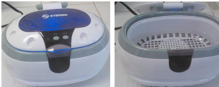
**Figura 3.11.** *Tina ultrasónica Steren Modelo USC-100.*
