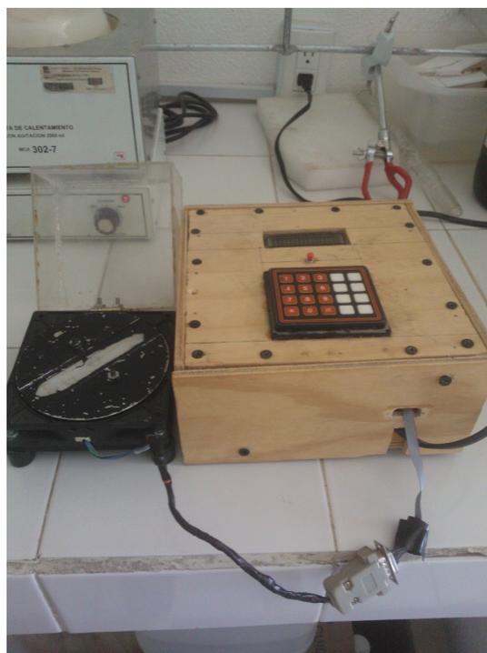
**Figura 3.17.** Spin Coater utilizado.
