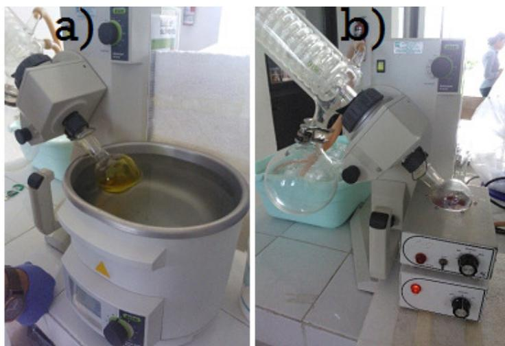
**Figura 3.3.** a) Montaje convencional del rota-vapor. b) Adaptación con la parrilla.
