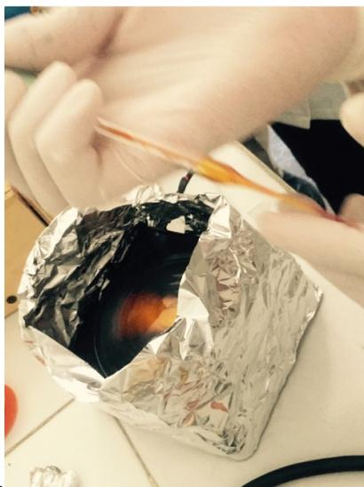
**Figura 3.21.** Depósito de la solución de C60 y P3HT.
