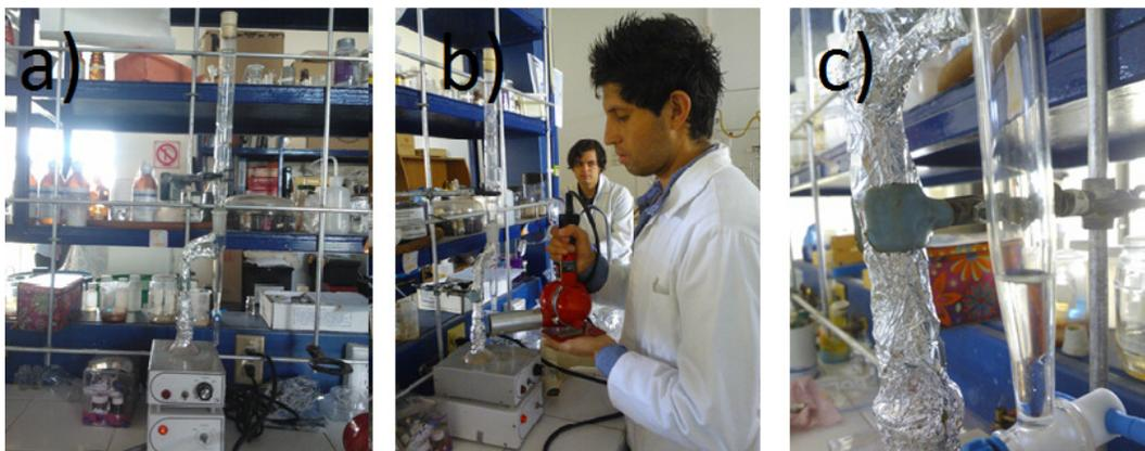
**Figura 3.4.** a) Montaje de los instrumentos usados. b) calentamiento de la trampa Dean- Stark. c) disolvente extraído.
