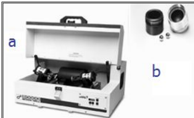
Figura IV.4. (a) Molino Spex marca 8000D con doble mezcladora y (b) contenedores de acero grado herramienta D2 con balines de acero cementado.
