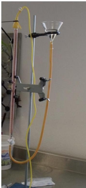
**Figura 3.** Sistema de medición de gas por desplazamiento de agua.
