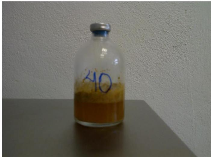
**Figura 1.** Vial de vidrio de 120 mL con boca de 20 mm utilizado para la incubación de los sustratos por la técnica de producción de gas.
