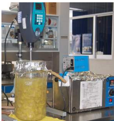
Figura 7. Proceso de extracción fraccionada de polisacáridos pécticos en tanque agitado.
