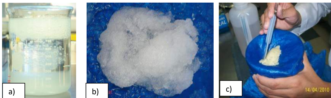
Figura 8. Recuperación del polisacárido péctico de xoconostle del medio de extracción a) precipitación con etanol, b) polisacárido recuperado, c) lavado con etanol.
