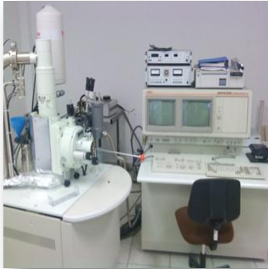
Figura 4.4. Microscopio Electrónico de Barrido marca Jeol, modelo 6300.
