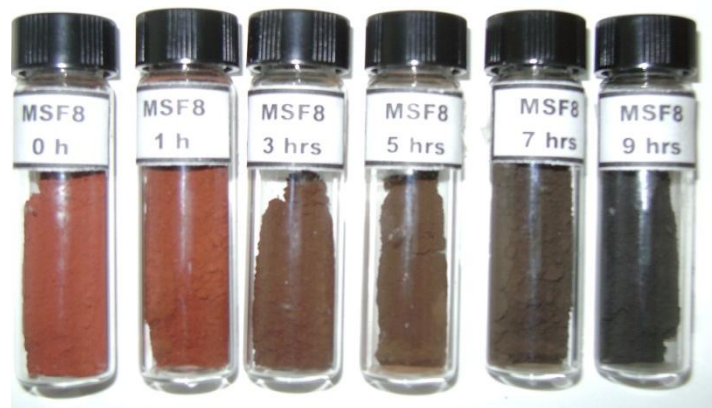
Figura 4.3.- Aspecto de las mezclas de óxidos precursores sometidos a diferentes tiempos de molienda.
