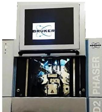
Figura 27. Difractor de rayos X, marca Bruker modelo D2 Phaser (Fuente: Creación propia).
