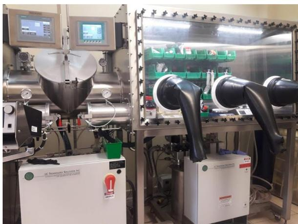
Figura 23. Caja de acero inoxidable con 3 guantes, marca LC Technology Solutions Inc., con bomba de vacío (Fuente: Creación propia).
