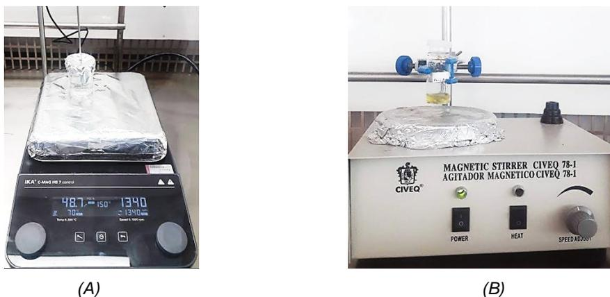
Figura 22. Parrillas de calentamiento y agitación: (A) Marca IKA, modelo C-Mag HS 7 y (B) Marca CIVEQ, modelo 78-1 (Fuente: Creación propia).
