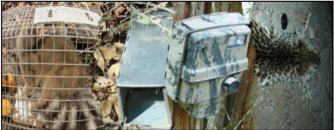
Figura 4. Métodos empleados para el registro de mamíferos terrestres (de izq. a der.: trampa Tomahawk, trampa Sherman, Trampas cámara y registros indirectos).
