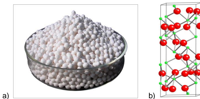
Figura 1.3 a) Alúmina activada, b) Estructura del Al 2 O 3 .
