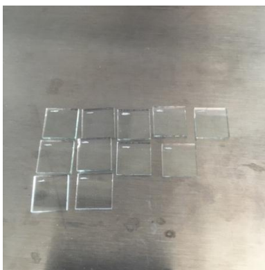
Figura 39. Sustratos marcados para identificar la superficie con ITO
