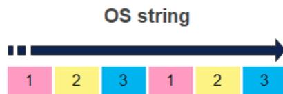
Figura III.10: Ejemplo de codificación de una cadena OS con 3 trabajos y 2 operaciones con permutación sin repetición.
