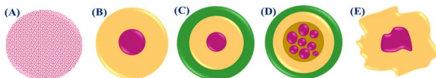
Figura 5. Esquema de varias morfologías de microencapsulación. A) microesfera, b) microcápsula monocapa mononuclear, C) microcápsula multicapa mononuclear, C) microcápsula multicapa multinúcleo E) micropartícula
