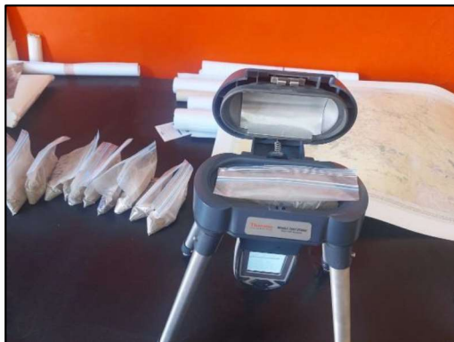
Figura 38. Procesamiento de muestras en FRX.
