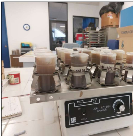
Figura 30. Agitación de muestras de sedimento para determinación por el método de extracto PECT.
