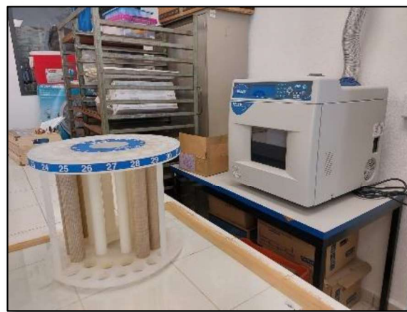
Figura 33. Digestión ácida por método EPA 3051.
