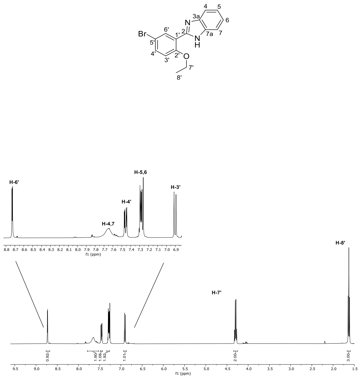
Figura 15. Espectro de RMN de ^1\text{H} (400 MHz) del compuesto 4 en \text{CDCl}_3 .
