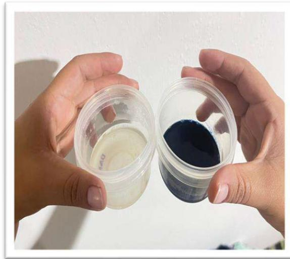
**Figura. 3 Reacciones en prueba simple de detección de yodo.**
