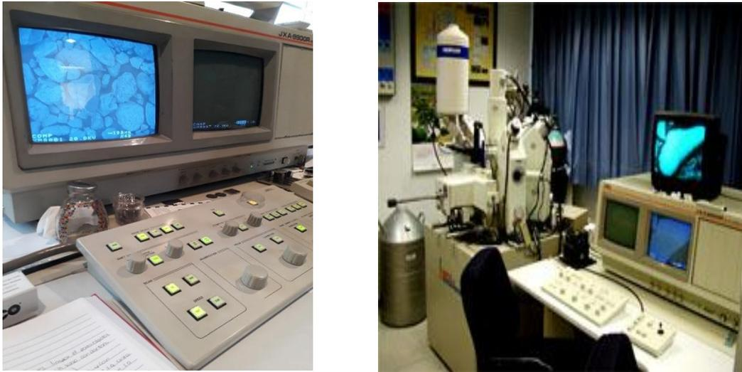
**Figura 4. 2 Microsonda electrónica de barrido del Laboratorio de Petrología del Instituto de Geofísica de la UNAM.**
