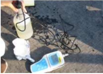
Figura 4.2. Medición in situ de temperatura y pH.
