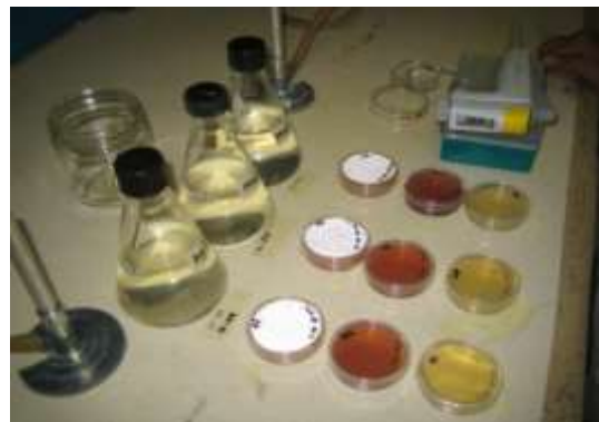
Figura 4.3. Ensayos de desinfección con agua de secundario.
