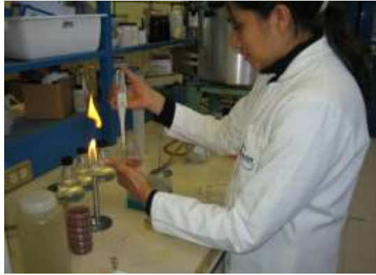
Figura 4.4. Toma de muestras a diferentes tiempos y con diferentes concentraciones de hipoclorito de sodio.
