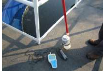
Figura 4.2. Medición in situ de temperatura y pH.
