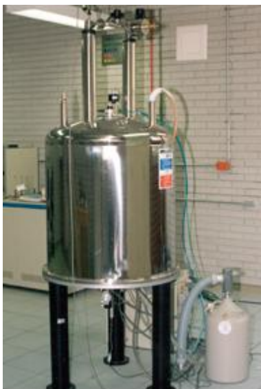
Figura 3.2.1. Equipo de Resonancia Magnética Nuclear “VARIAN 400 MHz”.
