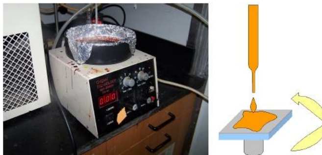
Figura 3.4.2.1. Dispositivo y técnica de spin-coating. Una porción de material orgánico en solución se coloca sobre un sustrato a recubrir, rotándose para obtener una película delgada y uniforme.
