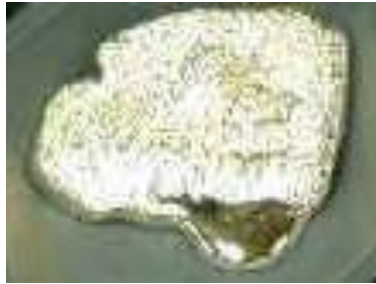
Figura 3.7.3. Apariencia física de la aleación Indio-Galio eutéctico, utilizado como cátodo para el OLED.
