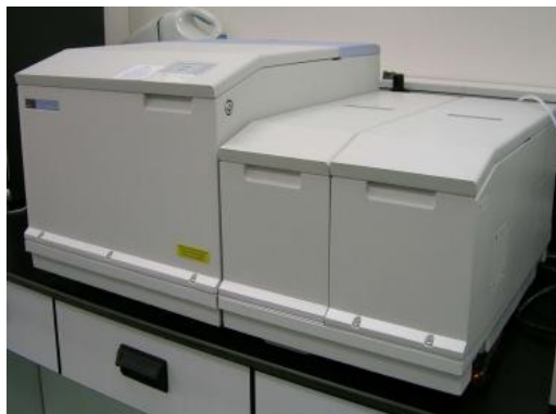
Figura 3.2.2. Espectrofotómetro IR-FT “Perkin Elmer Spectrum GX”
