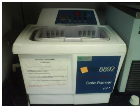
Figura 3.4.1.1. Equipo de ultrasonido para el lavado de los sustratos.
