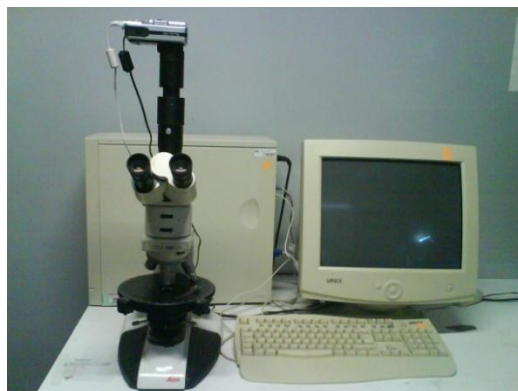
Figura 3.6.1. Microscopio óptico “Leica DM EP” utilizado para observar la superficie de las películas orgánicas depositadas sobre el sustrato de vidrio.
