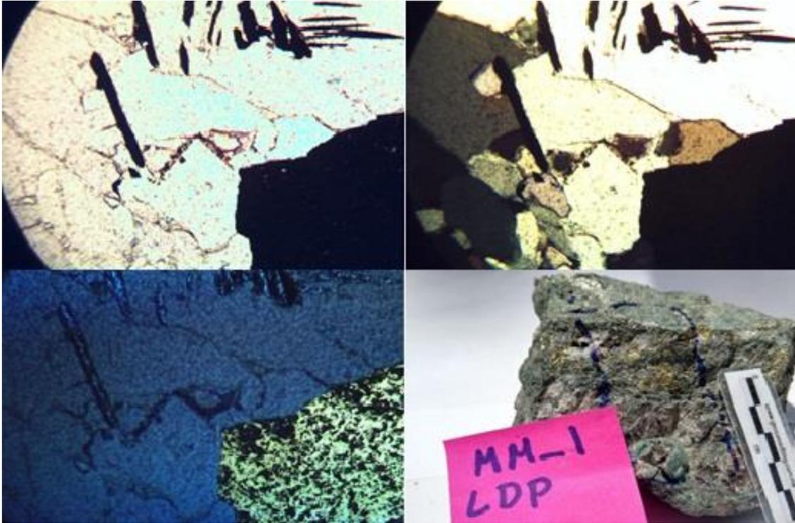
*Figura 15. Fotomicrografías de una veta de cuarzo, A) nicoles paralelos: se aprecian minerales opacos, B) nicoles cruzados: cristales euhedrales de cuarzo con minerales opacos, C) luz reflejada: cristales de calcopirita y calcosita, D) muestra a nivel muestra.*
