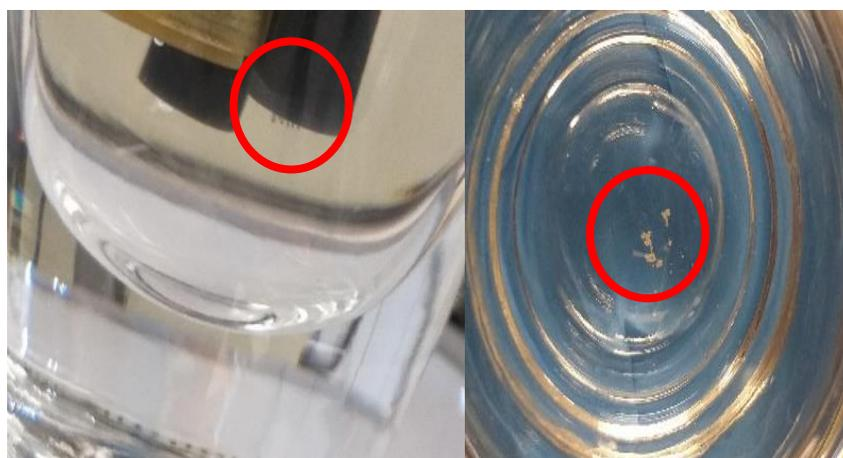
Figura 13. Observación de crecimiento 3D de óxido de plata sobre la superficie del electrodo de trabajo y desprendimiento de sólido del electrodo.
