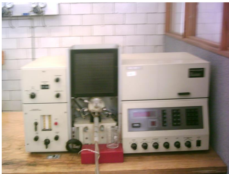
Figura 2.8. Espectrofotómetro de Absorción Atómica marca Perkin Elmer modelo 2100.
