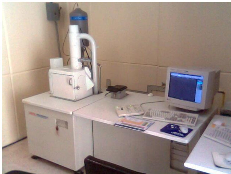
Figura 2.7. Microscopio Electrónico de Barrido de bajo vacío, Jeol JSM 5900LV.
