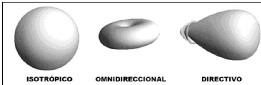
Figura 1.4. Patrones de radiación en una antena RFID (Intermec, 2010).
