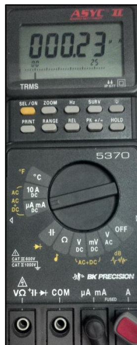
Figura 3.11. Medición de la corriente a través de la bobina.
