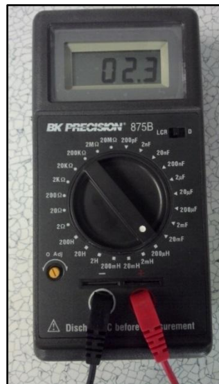
Figura 3.8. Medición de la bobina creada.
