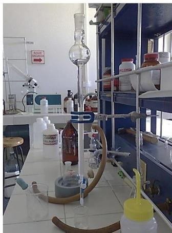
**Figura 23. Purificación del 1,4FBAC mediante cromatografía en columna.**
