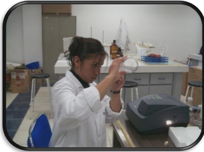
Figura 3.3. Detalle de la determinación de nitrógeno amoniacal ( \text{NH}_4^+ ) por espectrofotometría de absorción de radiación visible.
