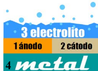
Fig I.1Partes que componen un sistema de corrosión.
