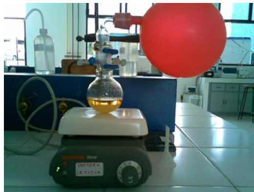
Fig. II.2 Sistema empleado para la síntesis convencional de los compuestos S y R imina
