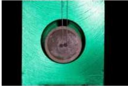
Figura 14 Ensayo de resistencia de unión por cizallamiento.
