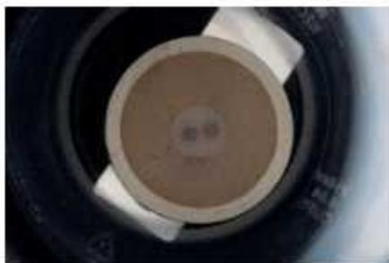
Figura 13 Almacenamiento de los especímenes en agua destilada.
