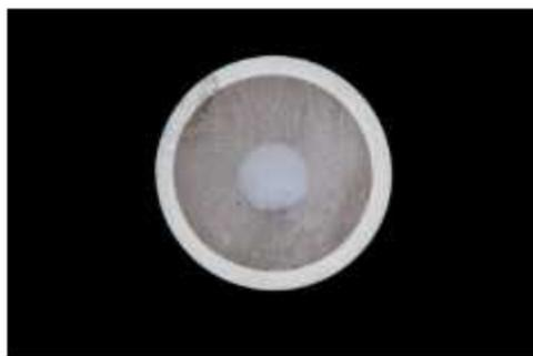
Figura 8 Especímenes de resina compuesta embebidas en resina acrílica dentro de tubos de PVC.
