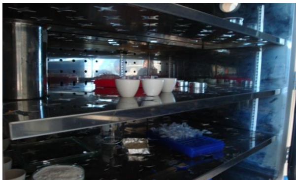
Figura No. 9. Imagen que muestra las capsulas de porcelana dentro de la estufa donde se llevo a cabo la determinación de humedad.
