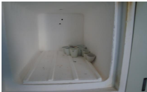
Figura No. 10. Imagen que muestra las capsulas de porcelana dentro de la mufla para la determinación de ceniza
