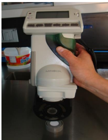
Figura No.12 Determinación del color de las diferentes mieles del Estado de Hidalgo.
