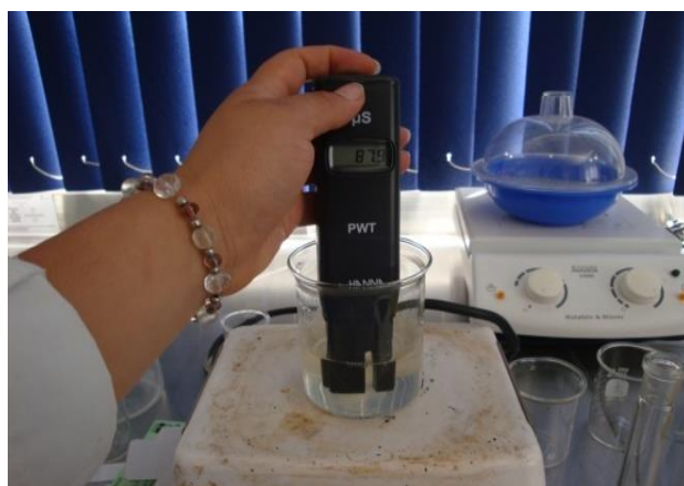
Figura No.11. Medición de la conductividad eléctrica de las muestras de miel del Estado de Hidalgo.
