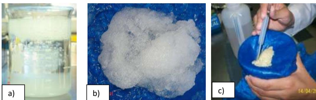
Figura 6. Recuperación del polisacárido péctico de xoconostle del medio de extracción a) precipitación con etanol, b) polisacárido recuperado, c) lavado con etanol.
