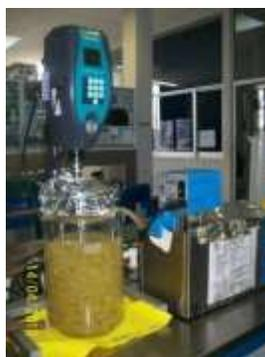
Figura 5. Proceso de extracción fraccionada de polisacáridos pécticos en tanque agitado.
