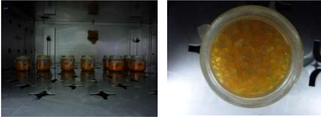
Figura 14. Celdas de medición con películas durante las pruebas de PVA.
