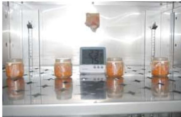
Figura 10. Películas ensambladas en frascos con agente absorbente, y colocadas en cámara ambiental para la determinación de la permeabilidad al vapor de agua por el método gravimétrico.
