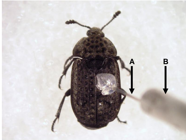
Figura 5. A) Aguja hipodérmica pegada a uno de los élitros de Thanatophilus graniger y B) termopar.
