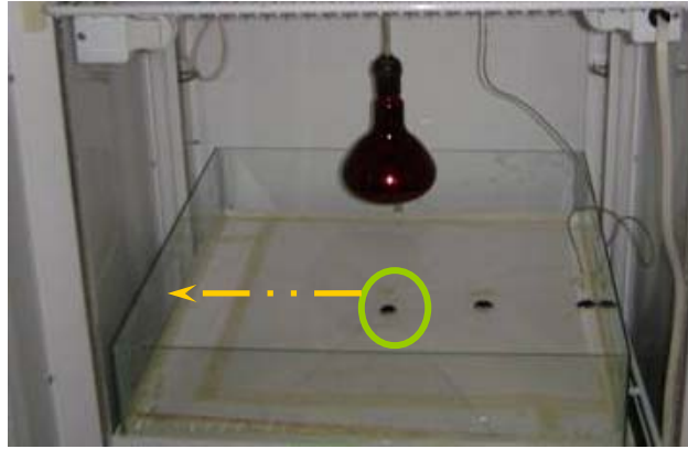
Figura 6. Método para determinar la preferencia de temperatura para el inicio de vuelo. La línea amarilla representa el gradiente de temperatura entre 18°C y 40°C en el centro (círculo verde).
