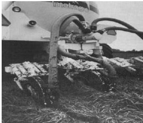
Figura 4. Equipo de inyección de biosólidos
